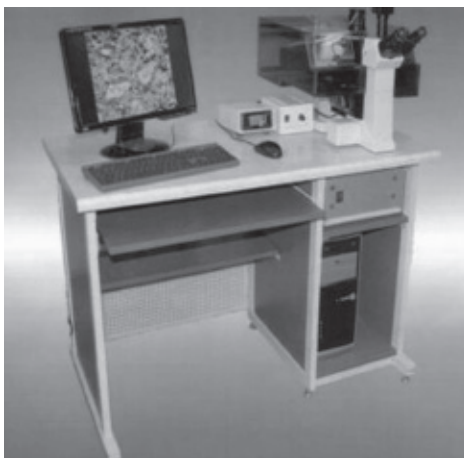
Рис. 3. Компьютерный видеокомплекс «Цитомир» для изучения живых клеток
